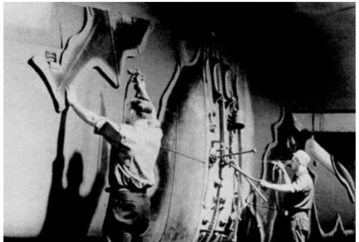
Rysunek 6.12.4 Malowanie płatów P-40 w zakładzie (Curtiss)
