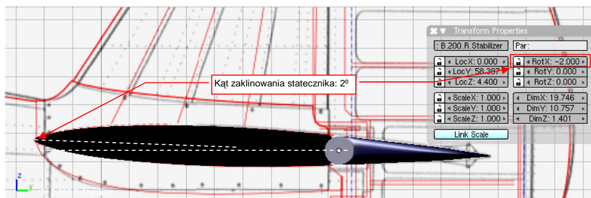
Rysunek 4.8.25 Umieszczenie usterzenia w docelowym miejscu modelu
