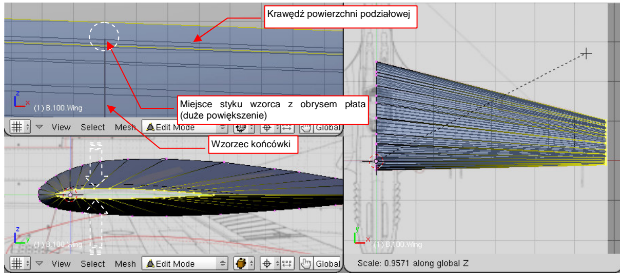
Rysunek 4.4.12 Dopasowanie grubości końcówki płata do zadanego wzorca
