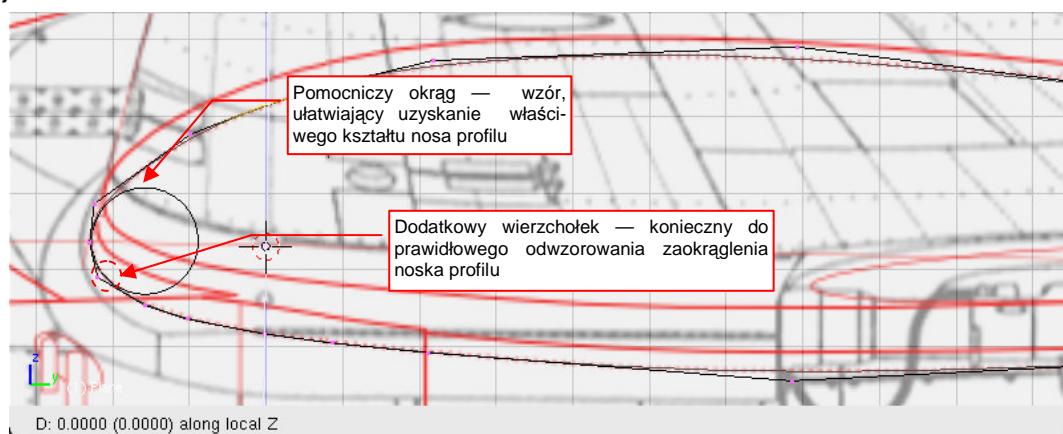
Rysunek 4.4.7 Formowanie nosa profilu — przykład wstawienia dodatkowego wierzchołka
